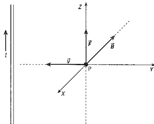
La fuerza que experimente el electrón será la debida al campo originado por la corriente que circula por el conductor. El valor de dicho campo en el punto  $P$ , que se encuentra a 2 cm del conductor, es:
