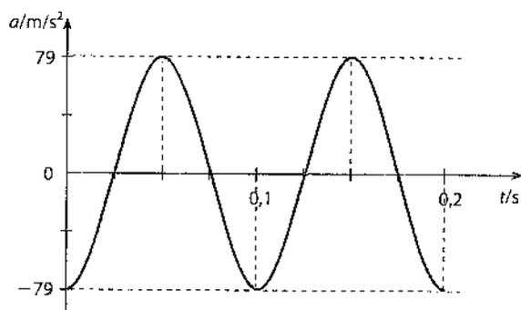
**28 PAU** Una masa de 200 g colgada de un resorte de constante  $k = 10 \text{ N/m}$  oscila con una amplitud de 4 cm. Calcula:
