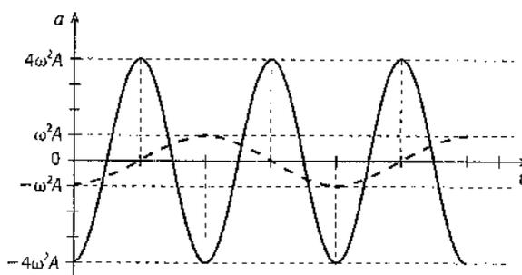
**10** Representa las gráficas de posición, velocidad y aceleración frente al tiempo de un cuerpo unido a un muelle que comienza a oscilar horizontalmente desde un extremo situado a 5 cm de la posición de equilibrio con una frecuencia de 5 Hz.
