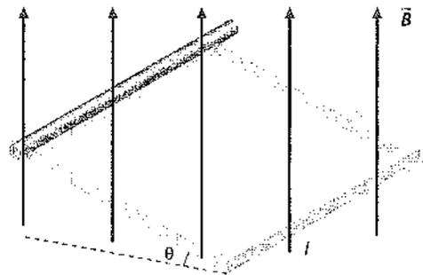
La varilla comienza a descender por acción de la componente tangencial de su peso ( $mg \sin \theta$ ). Debido a ese desplazamiento, las cargas adquieren una velocidad  $v$  en el sentido del descenso, lo que provoca la aparición de una fuerza magnética sobre ellas en la dirección del conductor móvil. En resumen, se induce una fem en la varilla, dada por:
