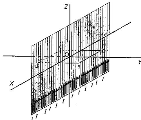
$$\oint \vec{B} \cdot d\vec{l} = \int_a^b \vec{B} \cdot d\vec{l} + \int_b^c \vec{B} \cdot d\vec{l} + \int_c^d \vec{B} \cdot d\vec{l} + \int_d^a \vec{B} \cdot d\vec{l}$$
