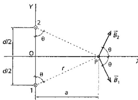
El campo magnético total será la suma de los campos creados por ambos hilos conductores. Por simetría, se observa que las componentes Y de los dos campos magnéticos
