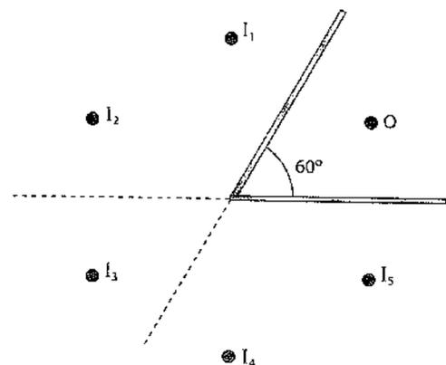
Las imágenes  $I_1$  e  $I_2$  son las producidas directamente por  $O$  en los espejos oblicuo y horizontal, respectivamente. La imagen de  $I_1$  es  $I_4$  en el espejo horizontal, mientras que  $I_2$  es la imagen de  $I_3$  en el oblicuo. Por último,  $I_3$  puede considerarse la imagen de  $I_4$  en el espejo oblicuo o la de  $I_2$  en el plano.
