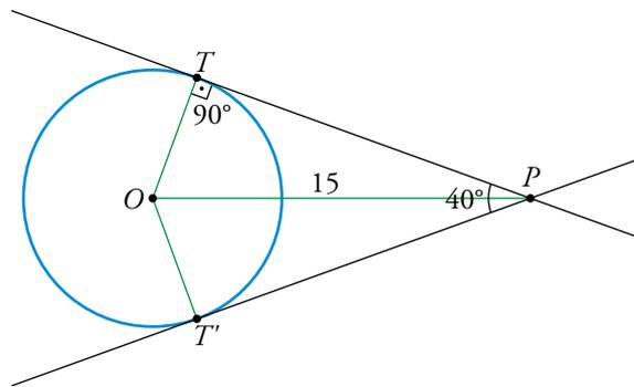
El radio  $\overline{OT}$  es el cateto opuesto al ángulo de  $20^\circ = \frac{40^\circ}{2}$ , luego  $\overline{OT} = 15 \cdot \text{sen } 20^\circ = 5,13 \text{ cm}$ .
