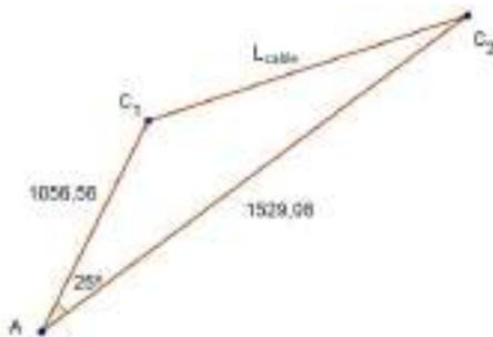
Determinamos la longitud del cable,  $L_{\text{cable}}$ , en el triángulo  $AC_1C_2$  aplicando el teorema del coseno:
