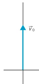
$$v_0 = \frac{1}{2} \cdot g \cdot t \Rightarrow v_0 = \frac{1}{2} \cdot 9,8 \text{ m/s}^2 \cdot 0,6 \text{ s} = 2,94 \text{ m/s}$$
